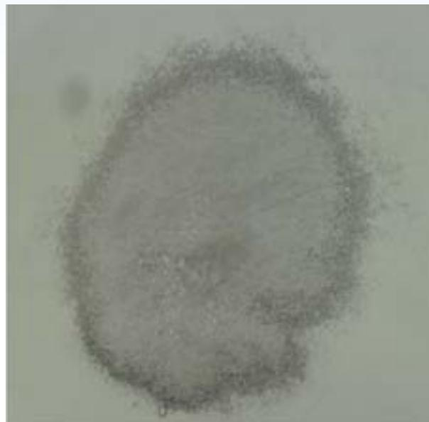
**Figura 30.** Patrón de entrega del *Spray* y Prueba de aspersión de Rinaid®. A la izquierda se observa una pulverización en forma homogénea y circular. A la derecha se observa el espectro de aspersión de la bomba atomizadora, realizada a 5 cm de distancia. *Data On File.*
